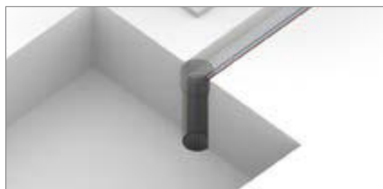
ZEMLJA/VODA - VERTIKALNI ZEMELJSKI KOLEKTOR
